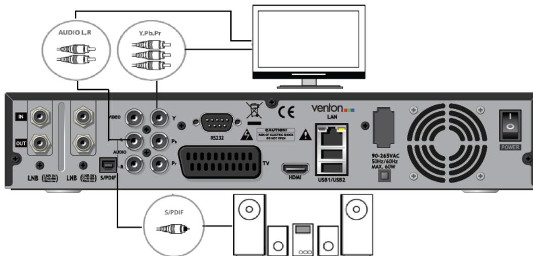
**BEMERKUNG:** Falls Sie über einen A/V Verstärker mit S/PDIF Digital Audio Eingang verfügen, wird diese Verbindung wegen der bestmöglichen Audio Qualität empfohlen, besonders für den Dolby Digital Ton.
